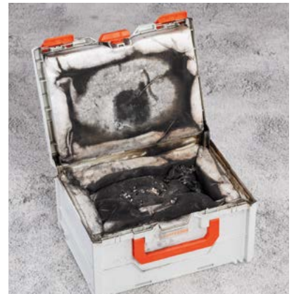
Erfolgreicher Brandversuch: die CEMO Brandschutzbox hält.
